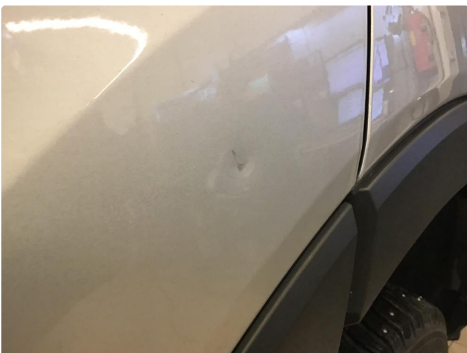
1.2 Liten bulk med lakkskade høyre framskjerm.
