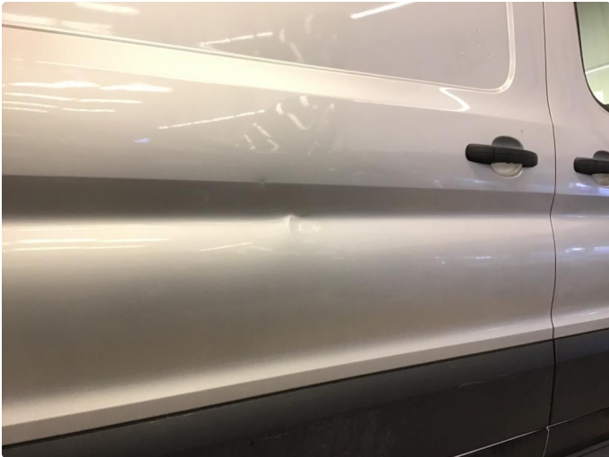
1.1 Flere bulker på høyre skyvedør.
