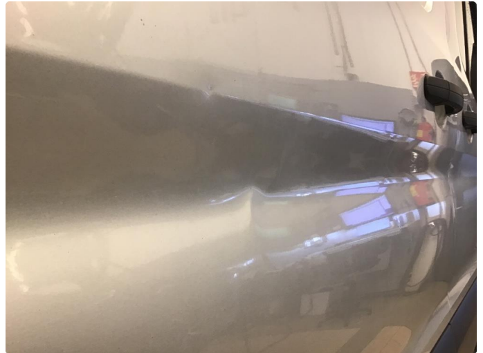
1.1 Flere bulker på høyre skyvedør.
