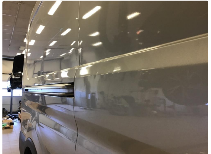
1.1 Flere bulker på høyre skyvedør.
