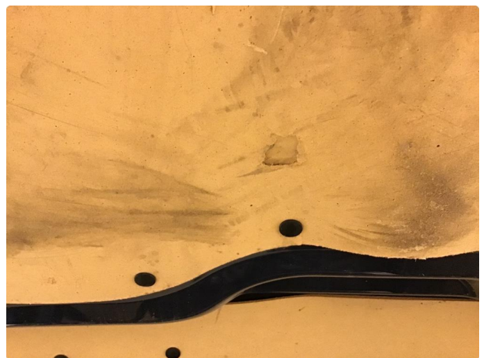
1.4 Skade på innvendig deksel bakluke.
