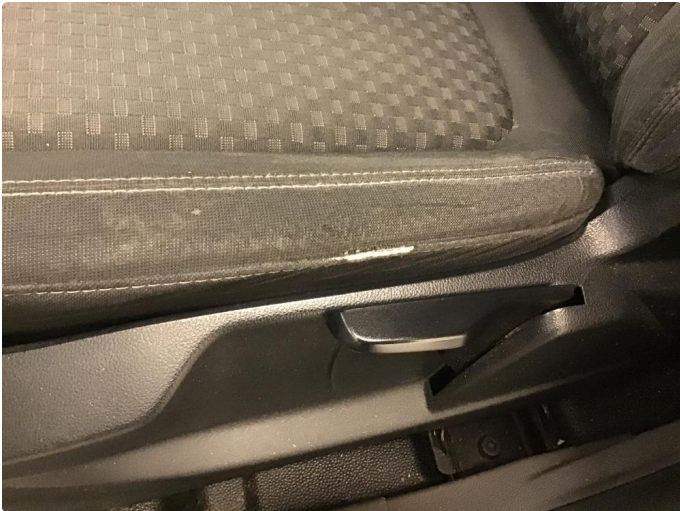
1.1 Noe slitasje på setetrekk fører sete.
