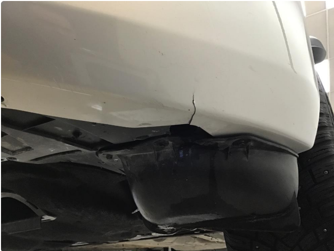
1.1 Liten skrubbeskade/liten sprekk under støtfanger foran venstre side foran.
