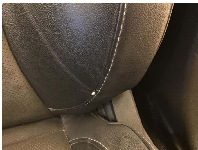
2.1 Liten skade på setetrek rygg førersete.
