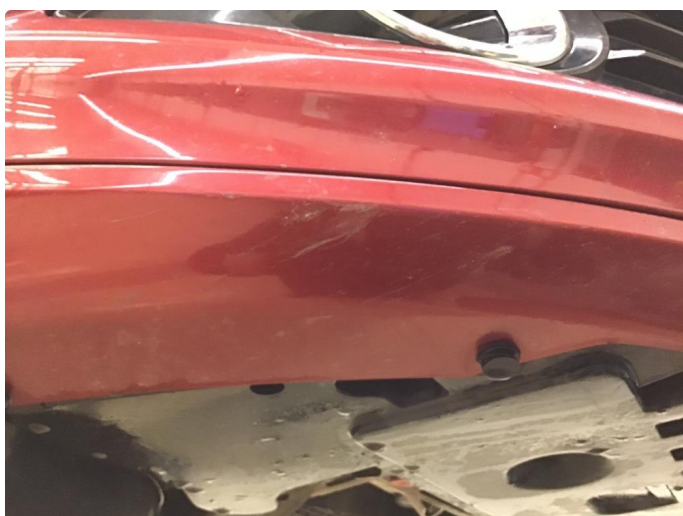
1.2 Noen små skrubbeskader under støtfanger foran.
