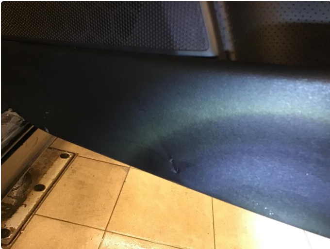
1.1 Liten skade på dørtrekk høyre bakdør.
