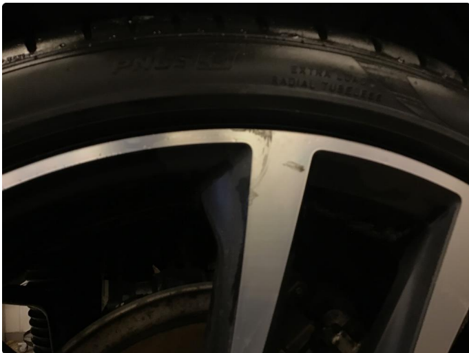
1.1 Noen riper på felg høyre bak.
