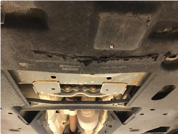
1.1 Liten skade på plate under motor.
