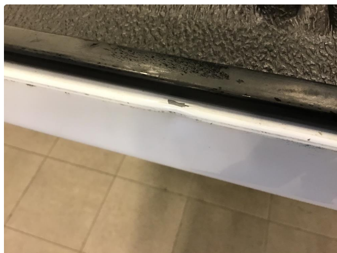
1.2 Bulk med lakkskade bakluke.
