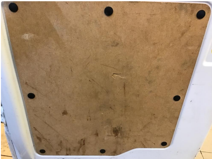
1.1 Liten skade på dørtrekk høyre bakdør.
