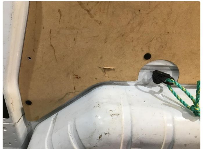
1.2 Liten skade på nedre deksel høyre side bak i lasterom.
