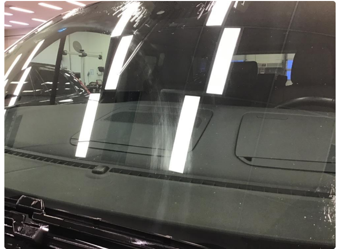
1.2 Noe slitasje på frontrute etter viskerblad.
