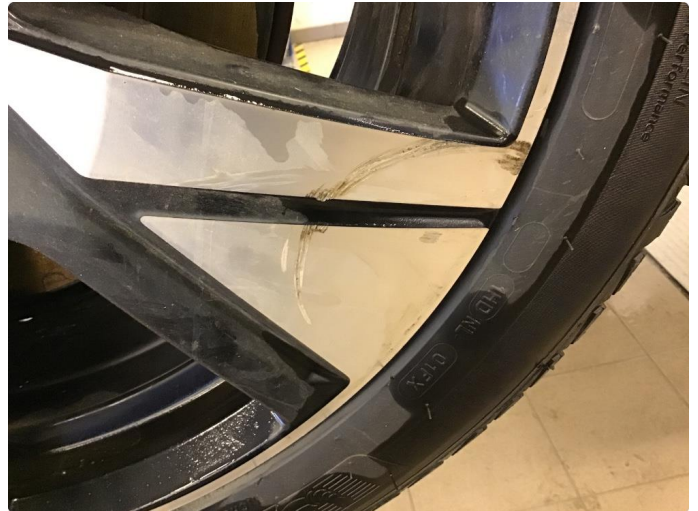
1.2 Skade / ripe på felg høyre bak.
