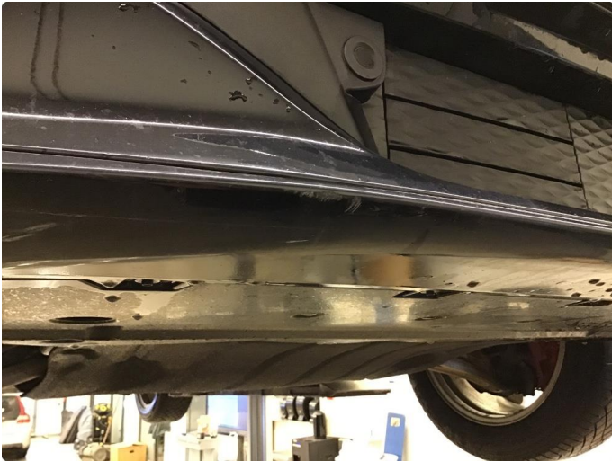
1.1 Noen skrubbeskader under støtfanger foran.
