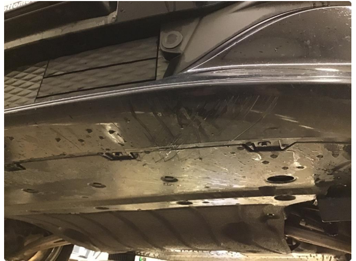
1.1 Noen skrubbeskader under støtfanger foran.
