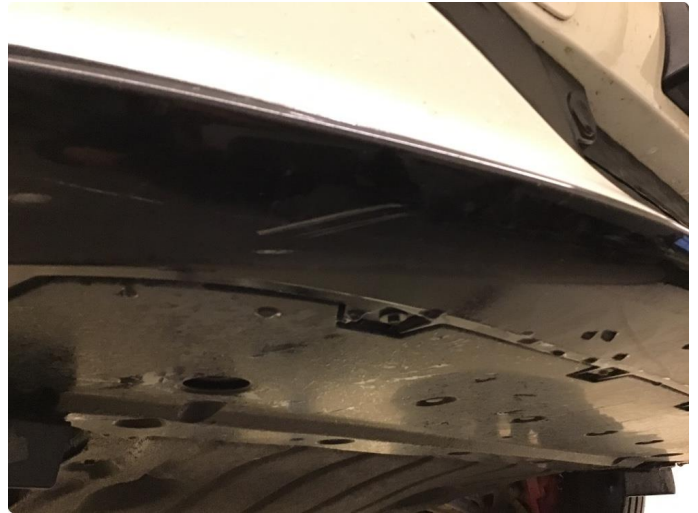
1.1 Noen skrubbeskader under støtfanger foran.
