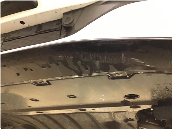
1.1 Noen skrubbeskader under støtfanger foran.
