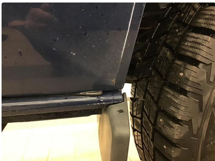
1.1 Slitt lakk, samt noe korrosjon
