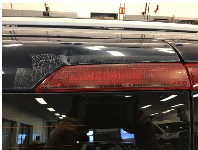
1.4 Bulk øvrekant venstre bakdør.
