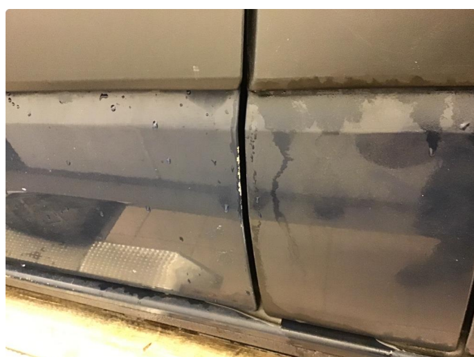
1.1 Slitt lakk, samt noe korrosjon
