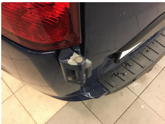
1.7 Lakkflass nedre dørhengsel venstre bakdør.
