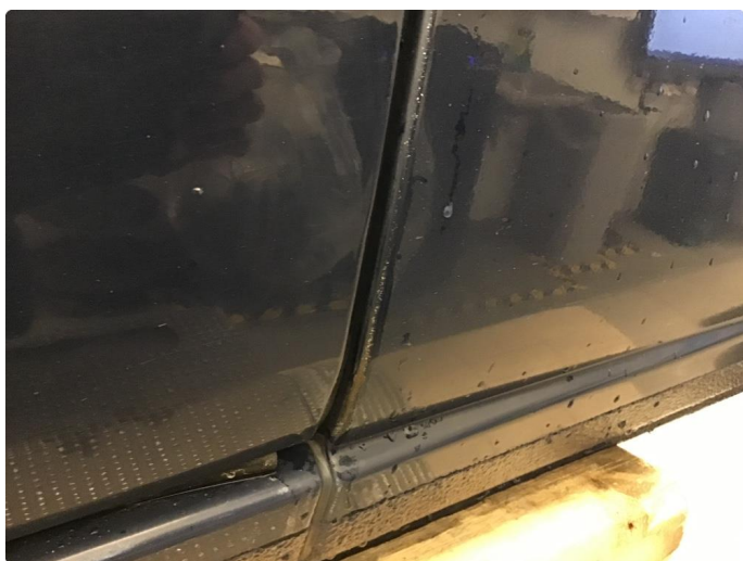
1.1 Slitt lakk, samt noe korrosjon
