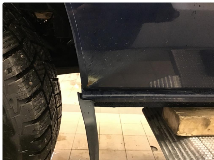
1.1 Slitt lakk, samt noe korrosjon
