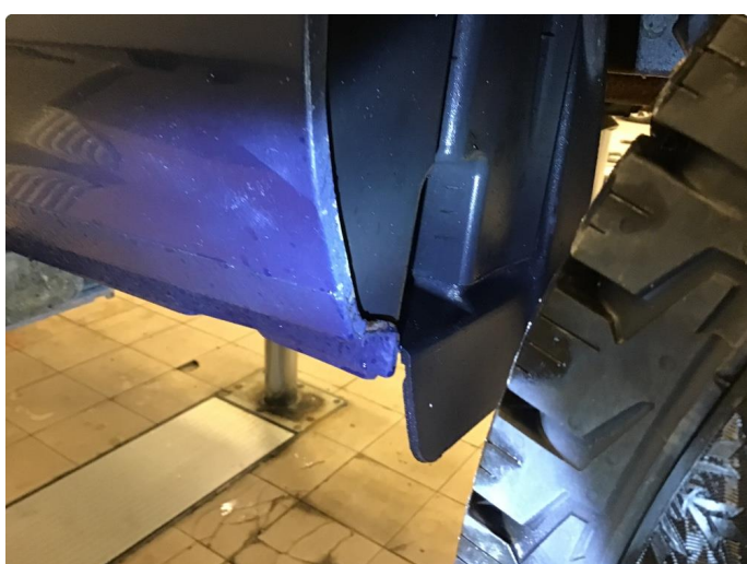
1.1 Slitt lakk, samt noe korrosjon
