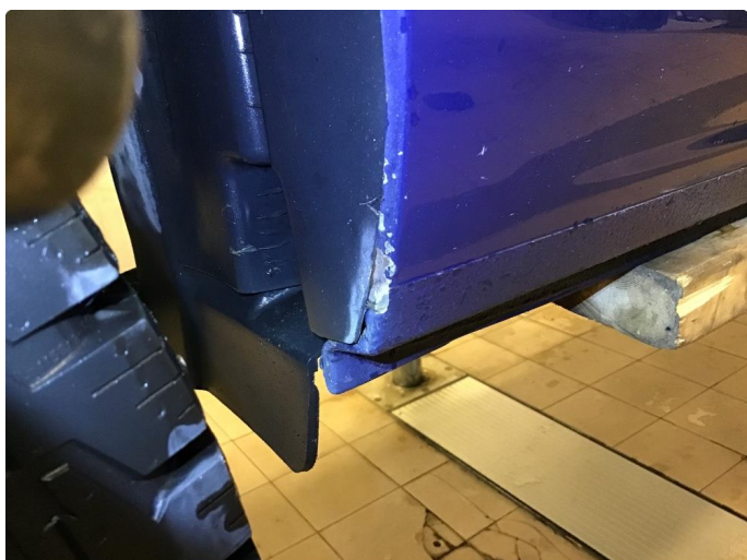
1.1 Slitt lakk, samt noe korrosjon
