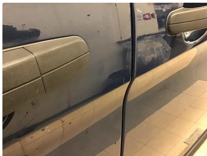
1.6 Liten bulk venstre framdør bak dørhåndtak.
