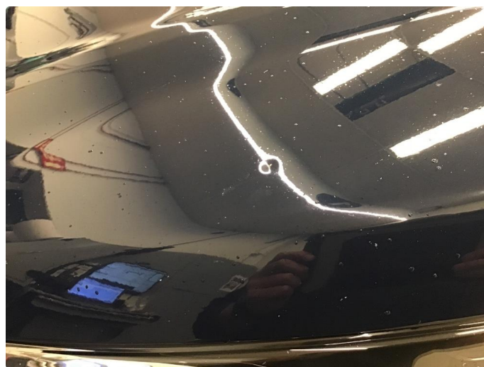
1.2 Liten bulk på panser venstre side.
