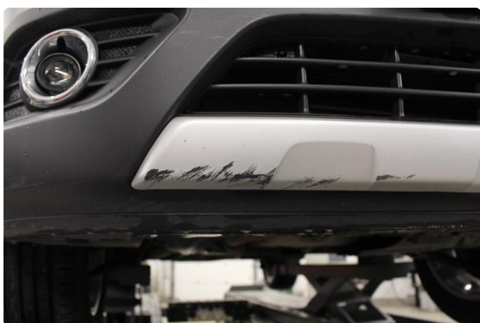
1.3 Ripe(r) ned til grunning
