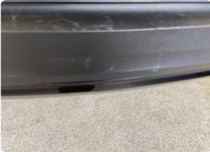
1.1 Skade/riper støtfanger bak
