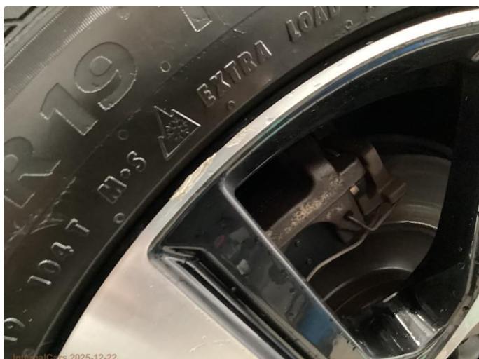
1.1 Kantkjørt vinterfelg høyre bak
