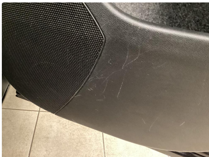
2.1 Skadet/merker etter utstyr
