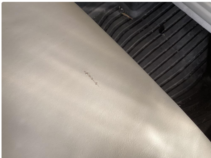
2.1 Skade på setetrekk
