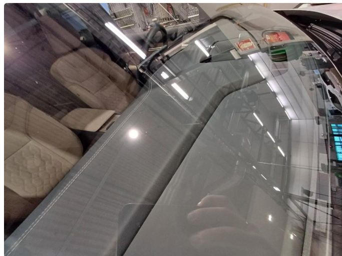
1.1 Stensprut i front og slitasje merke
