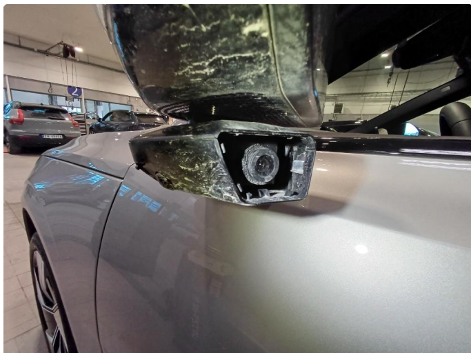
1.1 Stensprut i front og slitasje merke
