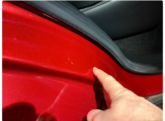
1.3 Merke i døråpning
