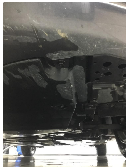
1.3 Ripe(r) ned til grunning
