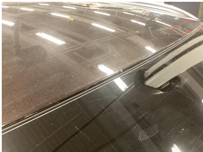
1.2 Steinsprut med rust
