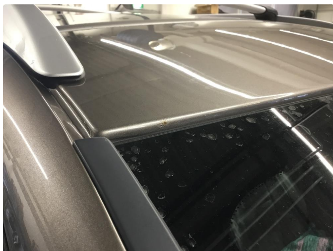
1.3 Steinsprut med rust
