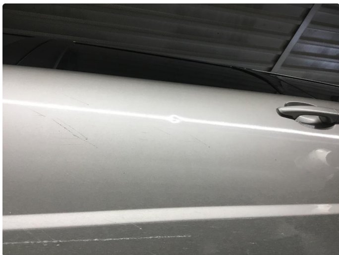
1.1 Noen riper og småbulker
