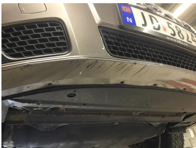
1.1 Noen riper og småbulker
