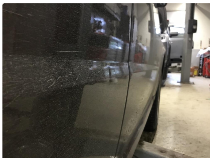
1.1 Noen riper og småbulker
