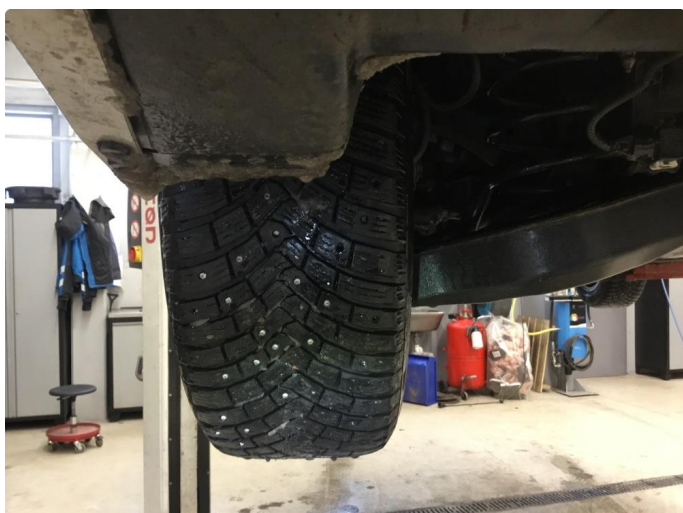
1.1 Piggdekk mangler pigger
