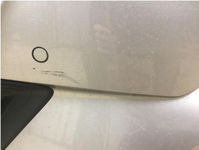
1.1 Ripe(r) ned til grunning
