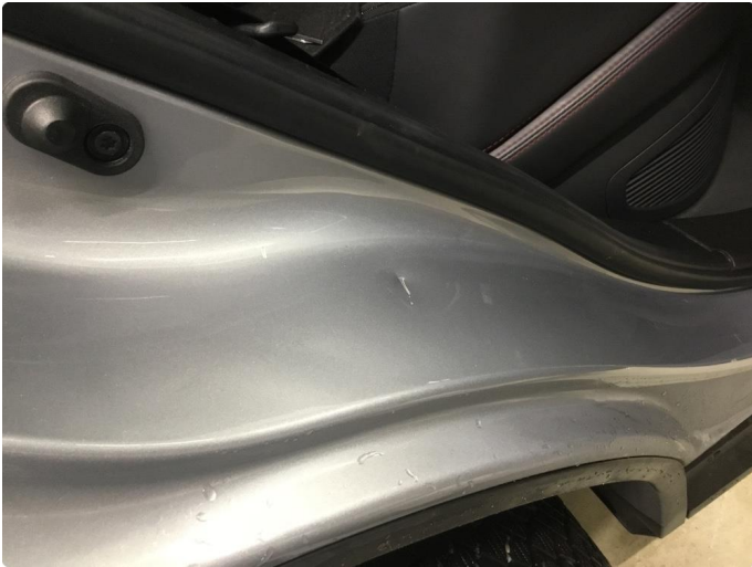
1.1 Bulk(er) med lakkskade
