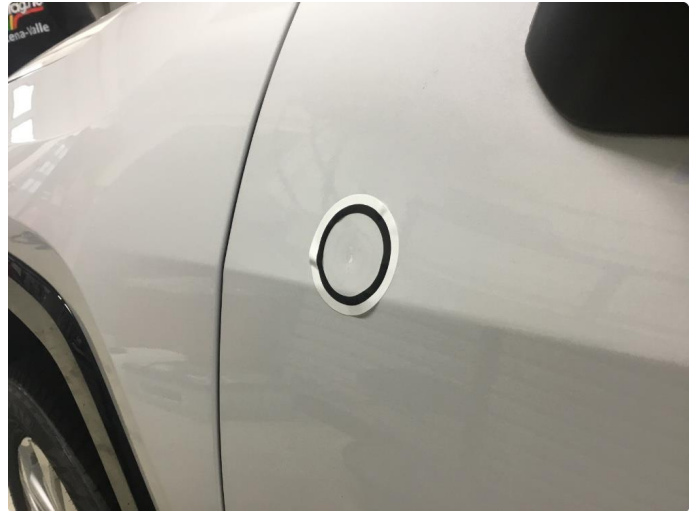
1.1 Bulk med lakkskade
