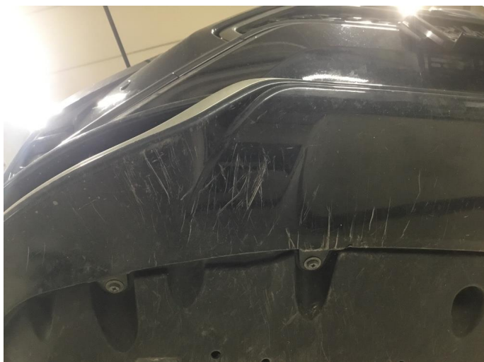
1.1 Ripe(r) ned til grunning
