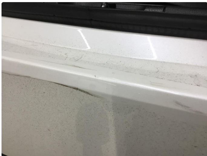
1.3 Ripe(r) ned til grunning
