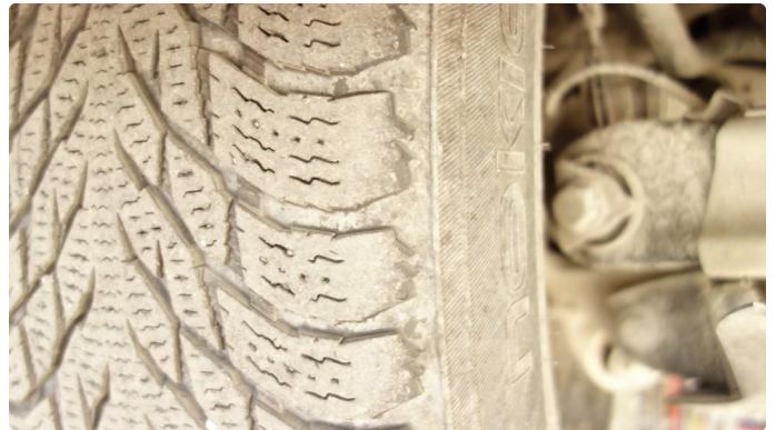
1.1 Skjev slitasje på vinterdekk
