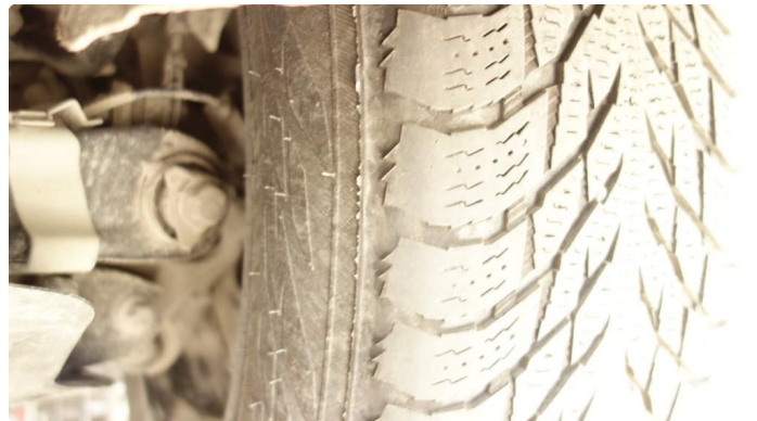
1.1 Skjev slitasje på vinterdekk
