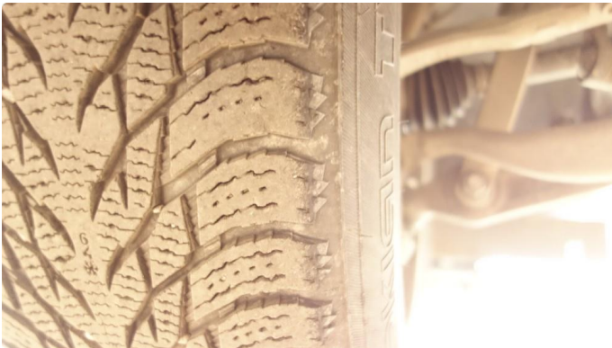
1.1 Skjev slitasje på vinterdekk
