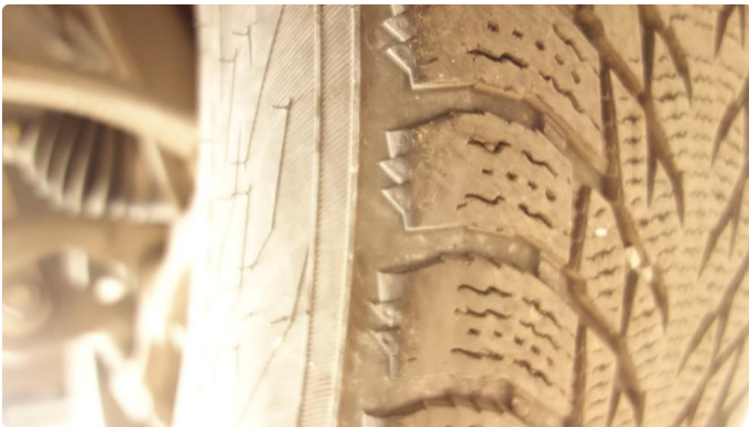
1.1 Skjev slitasje på vinterdekk
