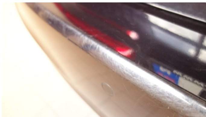
1.2 Slitasje innlasting, poleres
