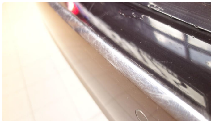
1.2 Slitasje innlasting, poleres
