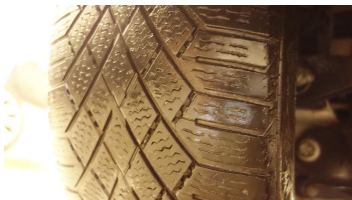
1.1 Skjev slitasje på vinterdekk
