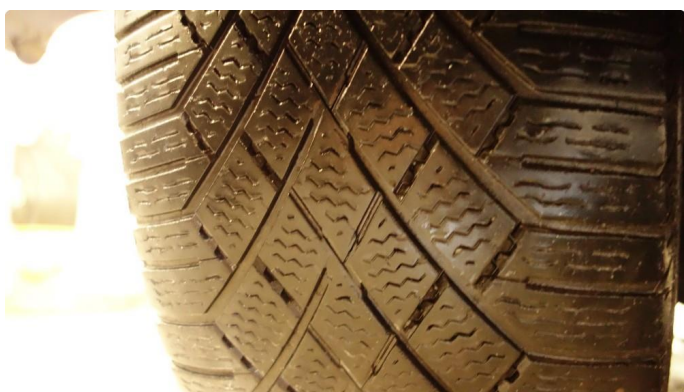
1.1 Skjev slitasje på vinterdekk
