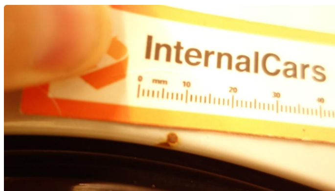
1.1 Steinsprut panser flekkes
