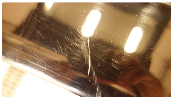
1.3 Ripe(r) ned til grunning
