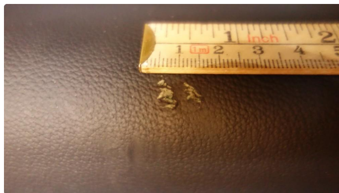
2.1 Skade på setetrekk
