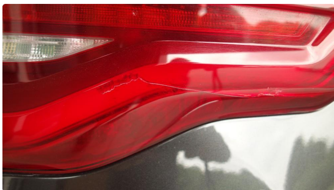
2.1 Defekt / sprukket glass
