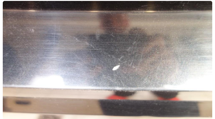
1.2 Ripe(r) ned til grunning
