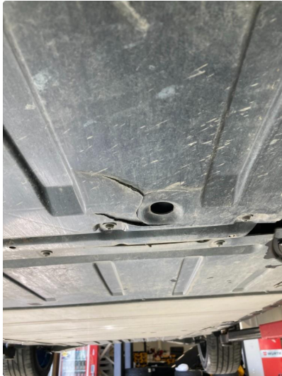
1.1 Liten sprekk i beskyttelsesplate under bilen
