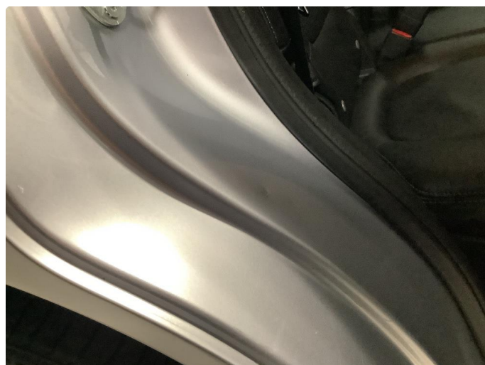
1.4 Bulk(er) med lakkskade - behandlet med flekkklakk
