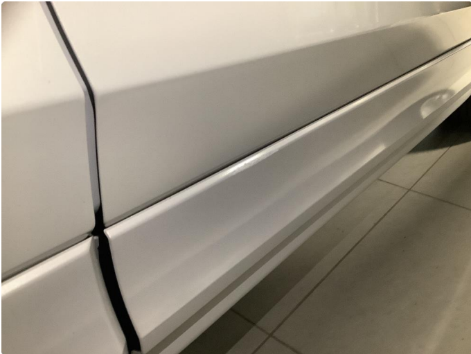
1.1 Lakkskade på plastdel på dør. Utbedret med flecklakk
