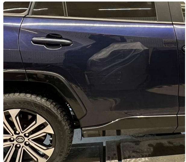
1.5 Bulk og riper bakdør høyre.
