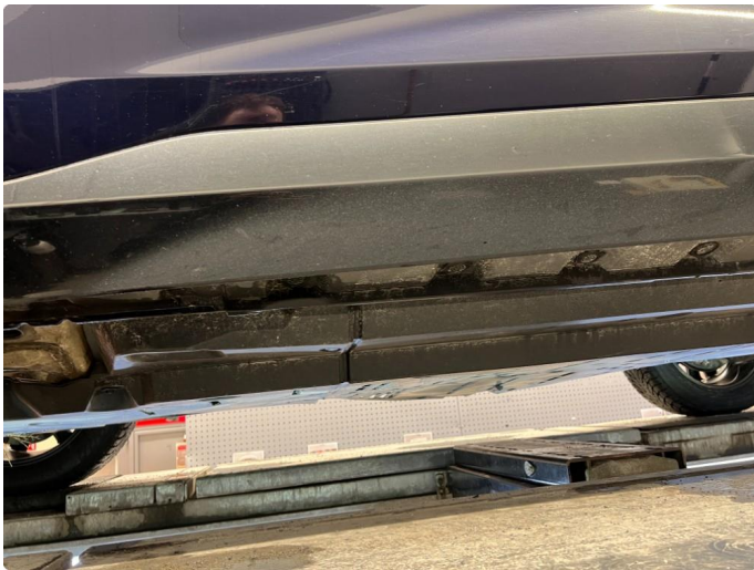
1.4 Slitt lakk nedre dørlister begge sider.
