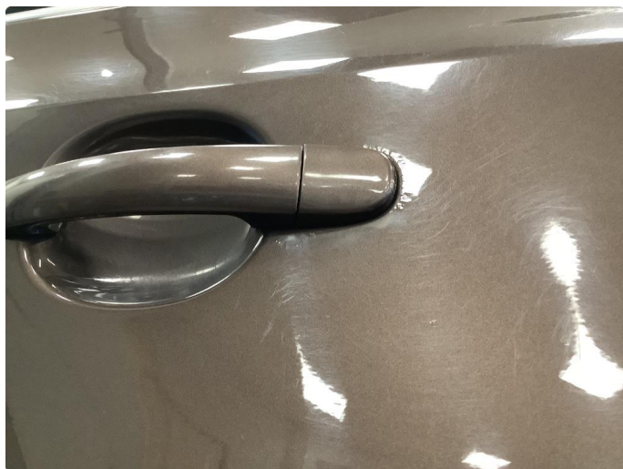
1.4 Påbegynnende rust rund dørhåndtak
