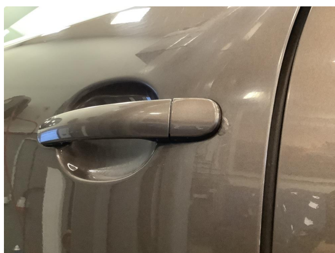
1.4 Påbegynnende rust rund dørhåndtak
