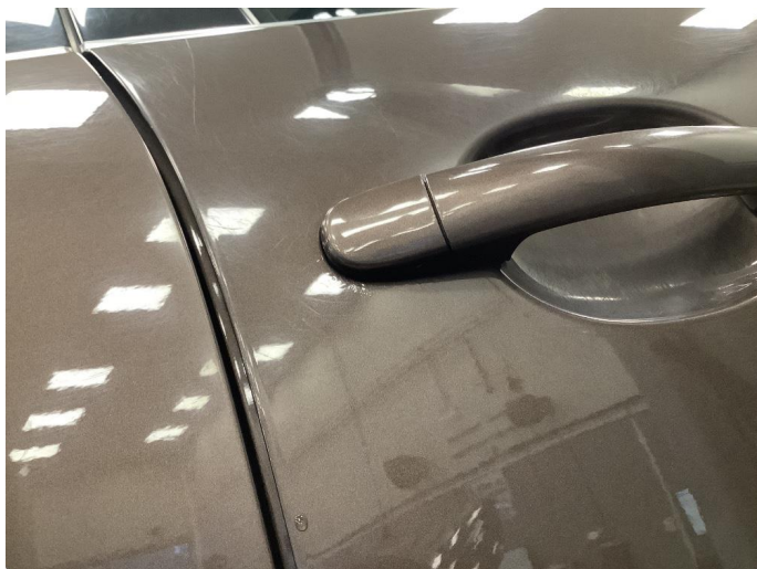
1.4 Påbegynnende rust rund dørhåndtak
