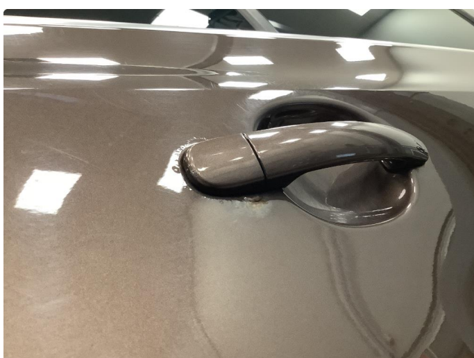
1.4 Påbegynnende rust rund dørhåndtak
