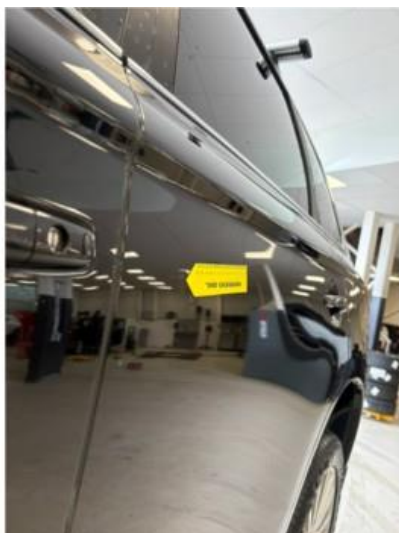
1.3 Liten bulk med lakkskade i dør venstre bak
