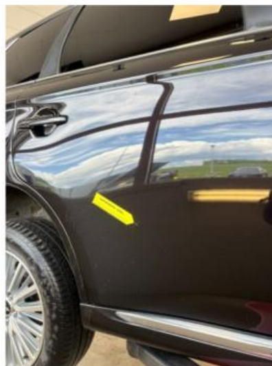
1.4 Liten bulk med lakkskade i dør høyre bak
