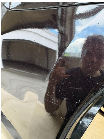
1.5 Noe riper i fanger bak. Dempes med rubbing og polering
