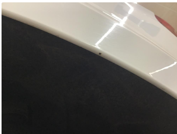
1.5 Steinsprut med rust
