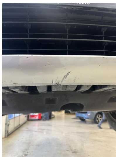
1.4 Litt oppripet på underside av fanger foran
