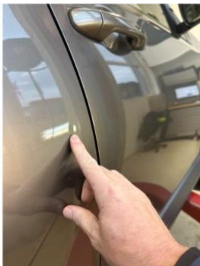
1.1 Liten bulk i dør høyre bak
