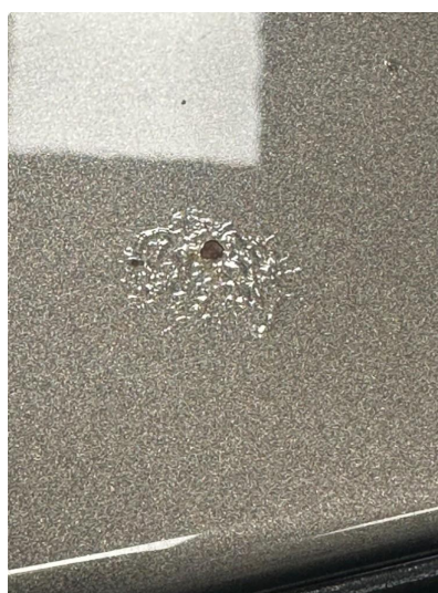
1.5 Liten steinsprut i forkant tak
