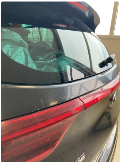
1.2 Noen riper i bakluke. Dempes med rubbing/polering
