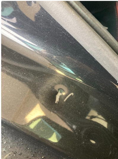
1.1 Liten bulk i døråpning høyre bak
