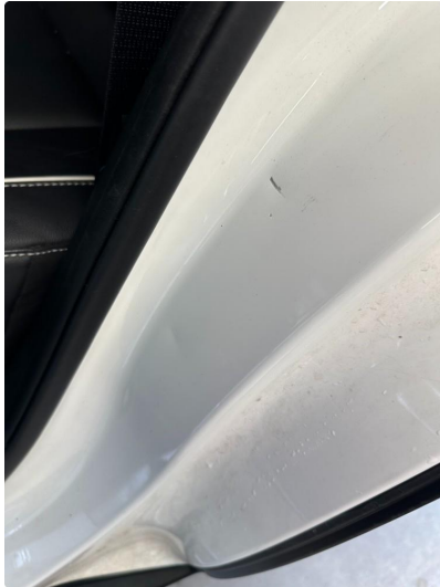
1.1 To små bulker døråpning venstre bak.
