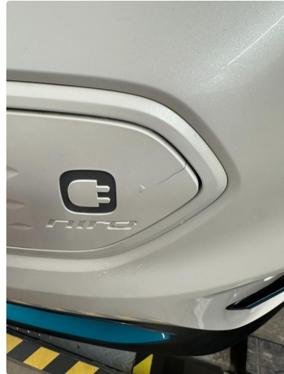
1.2 Sprekk i ladelukelokk
