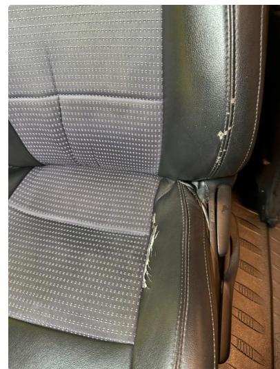
2.1 Noen rift i setetrekk venstre foran. Disse er ettermontert. Kan fjernes. Originaltrekk framstår som ny
